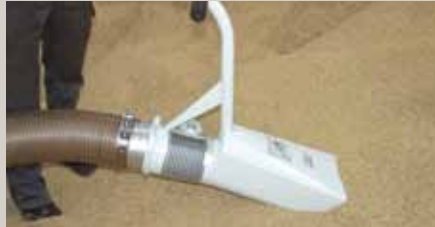
Cabezal de succión universal – El más versátil puede usarse en la mayoría de condiciones. Con este cabezal se consiguen máximos rendimientos.
