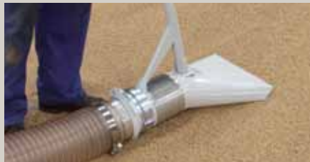
Cabezal de limpieza – Va muy bien para succionar los restos de grano en el suelo. Va equipado con ruedas y un enganche oscilante entre el cabezal y el tubo para que se adapte al contorno del suelo.
