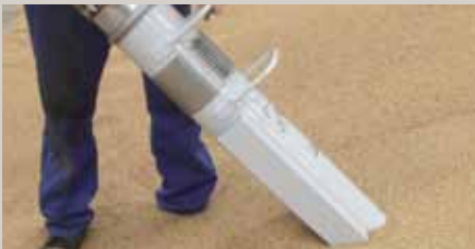
Cabezal de succión redondeado – Para succionar grano de un montón o desde la boca de un silo permite grandes capacidades.
