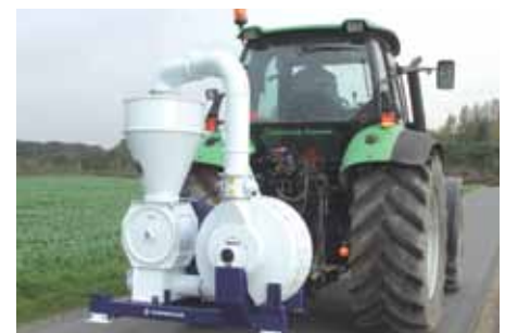
Las turbinas de succión tipo SUC-T se montan a los 3 puntos del tractor y se accionan a la toma de fuerza. Están disponibles en 2 modelos con capacidad hasta 33 t/h.
