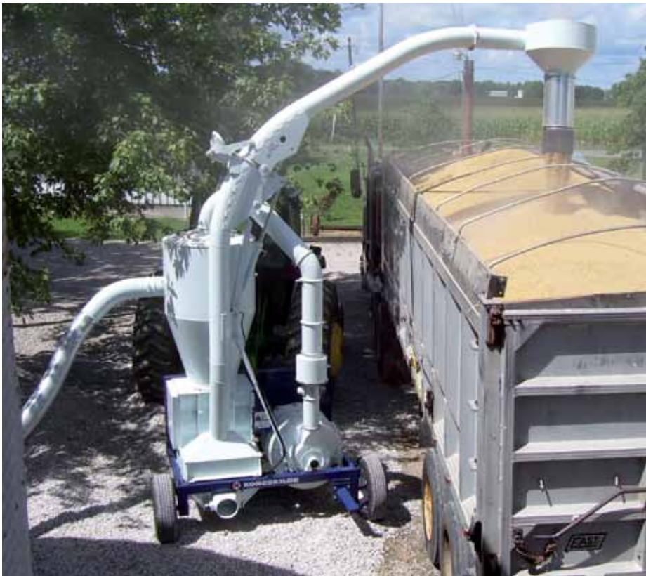
SupraVac 2000 es el modelo de más capacidad de la gama Kongskilde. Con una capacidad de 120 t/h el SupraVac 2000 carga rápidamente los remolques más grandes o camiones.
