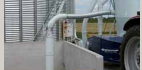
Cabezal de succión largo – Especialmente indicado para cargar desde fosos, permite una alta capacidad de aspiración. Este cabezal se puede extender con secciones de 65 cm.
